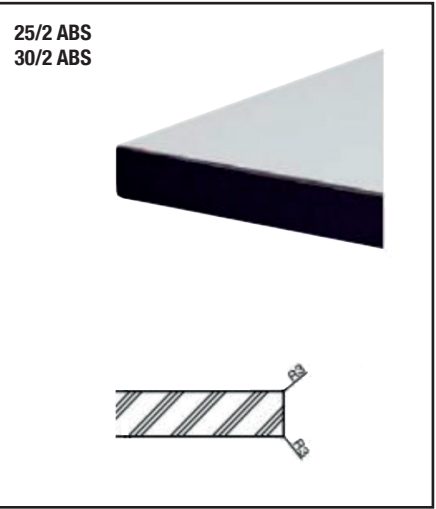
Kunststoffkante (ABS) Tischplatte 25 oder 30mm stark Oberfläche HPL, Tischplattenkante mit extra schlag-, kratz- und stoßfester Kunststoffkante 2mm ABS.
