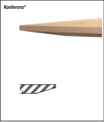
Hochwertige sehr stark abgeschrägte Tischplatte Multiplex-Tischplatte (Schichtholz), 30 mm stark, als Trägermaterial, Kante gefräst, natur lackiert oder gebeizt.
