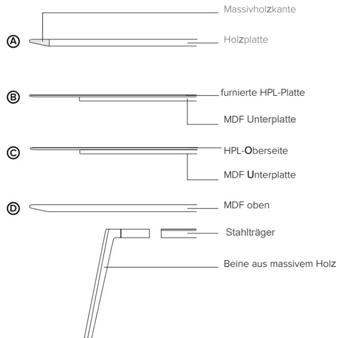
**B** Dekor HPL-Platte, 12 mm stark, auf einer 20 mm starken MDF-Unterlage montiert
